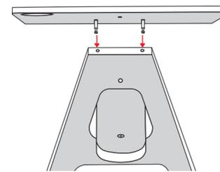
Tischplatte mit den Bolzen in Bohrungen einführen bis diese gut aufliegt.
