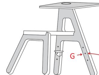
Mit den Schrauben **G** die Fußstützen in die gewünschte Höhe festschrauben.
