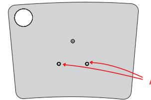
Die beiden Bolzen **A** in die Tischplatte schrauben.
